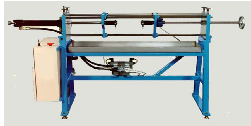
6 kip Test Frame
