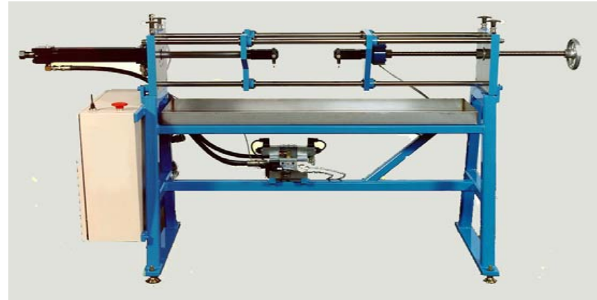
6 kip Test Frame
